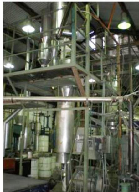
Reactor piloto de tostación de lecho fluidizado.
